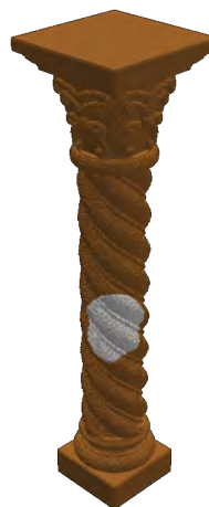
(d) Mesh of the repaired column
